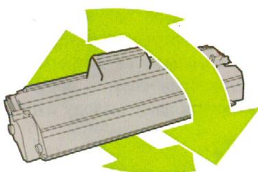
**Внимание!!! Обязательно перед установкой картриджа в принтер! Для равномерного распределения тонера внутри картриджа, перед началом использования, встряхните картридж в горизонтальном положении 6-8 раз. Это может сказываться на качестве отпечатков!!!**
