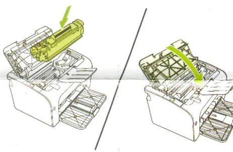
Установите тонер - картридж в лазерный принтер в соответствии с инструкцией пользователя принтера.
